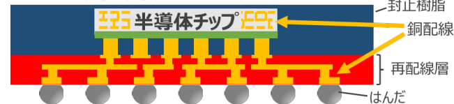
最先端半導体パッケージの断面イメージ図
